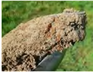
Figure 12 – Pseudogley caractérisant une oxydation de l'élément fer
